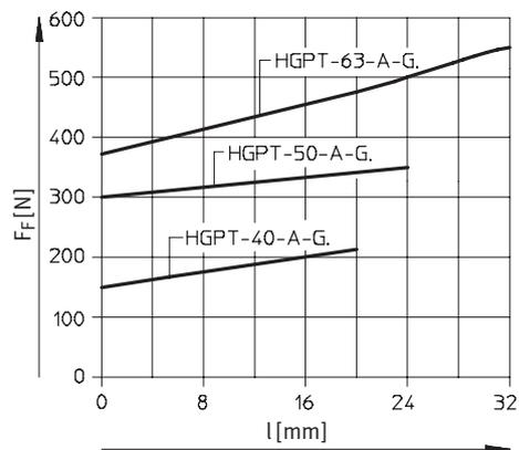
Zur Ermittlung der tatsächlichen Federkraft  $F_{Fges}$  muss der Hebelarm  $x$  berücksichtigt werden. In der nebenstehenden Tabelle stehen die Formeln zur Berechnung der Federkraft.
