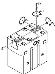
Die angegebenen zulässigen Kräfte und Momente beziehen sich auf einen Greifbacken. Sie beinhalten den Hebelarm, zusätzliche Gewichtskräfte durch das Werkstück bzw. durch externe Greiffinger und auftretende Be-
