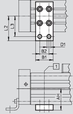
1 Position der Mittenstütze im Bereich des Profilrohrs frei wählbar
