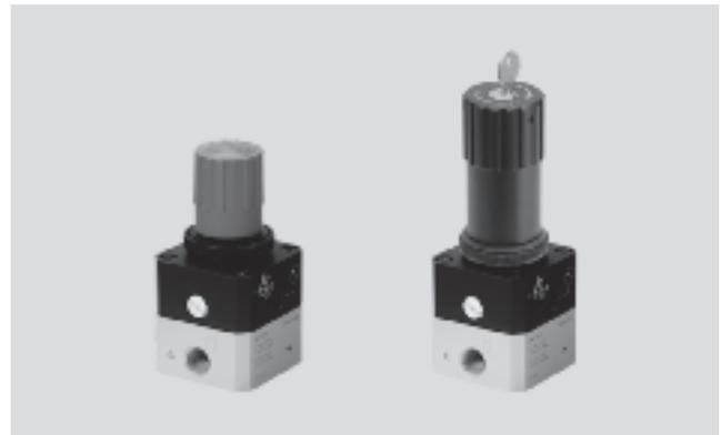
Questo riduttore di precisione controlla la pressione di lavoro (lato secondario) grazie al prepilotaggio ottenuto mediante la membrana che, agendo nella sede principale, permette di ottenere una migliore regolazione della pressione.
