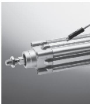
Sul pistone del cilindro è applicato un magnete permanente, il cui campo magnetico consente l'azionamento dei finecorsa senza contatto. I finecorsa
