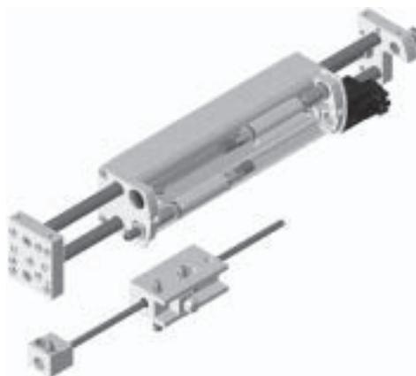
La cartouche de blocage bloque par friction la tige de blocage (sécurité en cas de chute de pression). La tige de blocage se fixe sur la plaque avant. Lorsque la cartouche de blocage est
