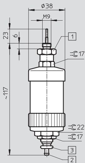
2 Boquilla enchufable para tubo flexible tipo PCN-4
