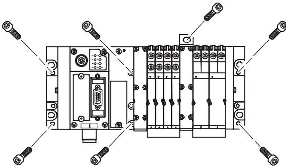
El terminal de válvulas MPA se fija a la superficie mediante cuatro tornillos M4 o M6. Los taladros para efectuar el montaje se encuentran en los siguientes lugares:
