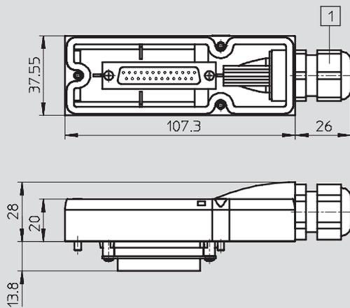
1) Conexión de cables en zona de fijación 6 ... 12 mm
