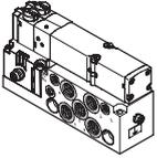
Para los terminales montados lejos de los actuadores, también se pueden utilizar válvulas montadas sobre placas base individuales.
