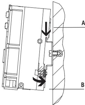
El terminal de válvulas MPA se cuelga en el perfil DIN (ver flecha A). A continuación se gira el terminal MPA y se fija mediante la pieza de bloqueo (ver flecha B).
