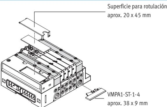
Para identificar las válvulas puede montarse en cada placa de alimentación de 42 mm de ancho un soporte de placas rotulables VMPA1-ST-1-4 (n° de art. 533 362, código T en el código de pedido) o VMPA1-ST-2-4 (n° de art. 544 384, con placas de identificación IBS-6x10).
