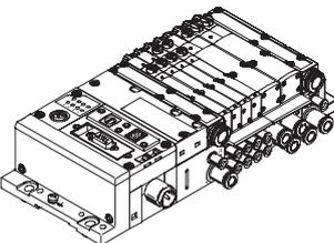
Los controles integrados en los terminales de válvulas de Festo permiten la creación de unidades de mando independientes (stand alone) con IP65 y sin armario de distribución.
