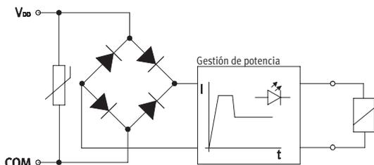
Cada bobina MPA tiene un circuito protector para supresión de arco voltaico y, además, tiene polaridad inconfundible.
