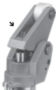
**Amortiguador integrado:** absorbe la energía del impacto y frena el portaobjetos con suavidad y silenciosamente. La energía del impacto puede regularse mediante un tornillo en el balancín.
