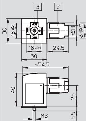
En estos conectores tipo zócalo, los cables no se conectan mediante tornillos individuales, sino mediante contactos autocortantes patentados.
