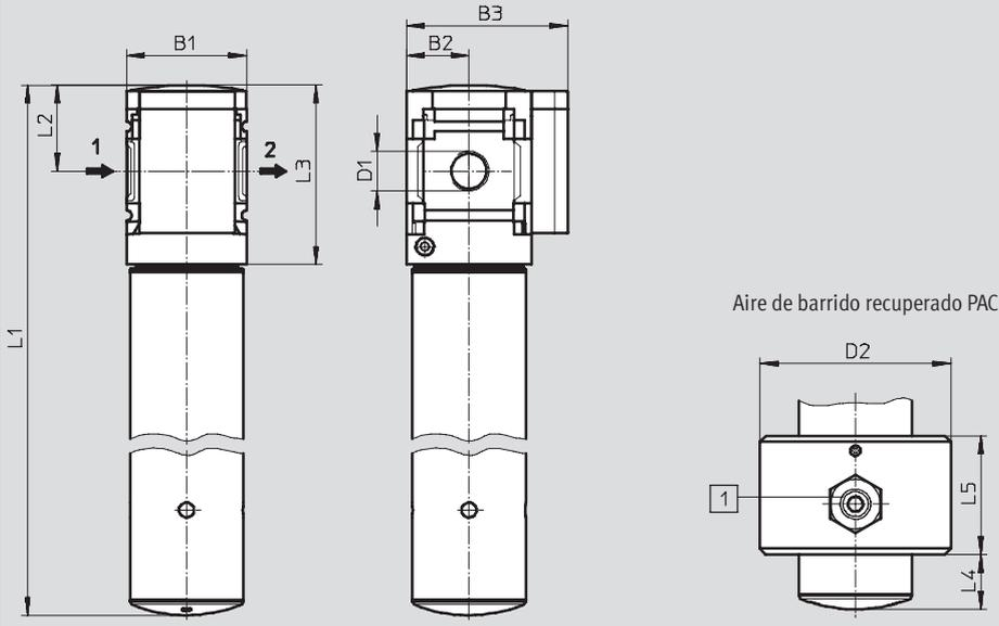
1 Racor rápido roscado QS-1/4-10 (incluido en el suministro) para tubos flexibles de diámetro exterior de 10 mm y diámetro interior mínimo de 7 mm.
