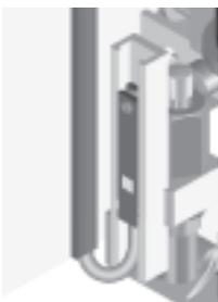
1 Los cables de los detectores se tienden en las ranuras y en la placa base.
