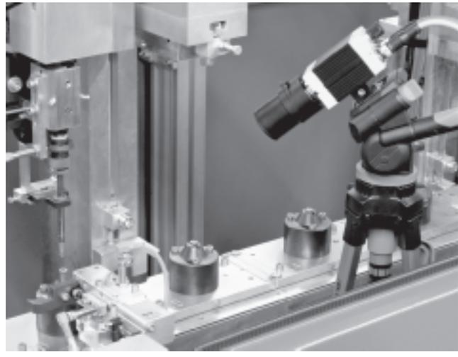
Stationäre Montage der Hochgeschwindigkeitskamera zur Erhöhung der Verfügbarkeit von Automatisierungsanlagen
