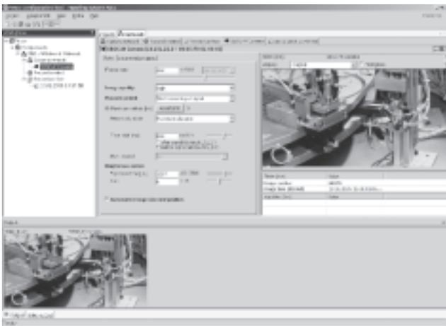
Anhand der Live-Bilder der jeweiligen Kamera können die Optik eingestellt und Parameter wie z.B. Belichtungszeit, Bildrate, Aufzeichnungsdauer und Bildqualität angepasst werden. Mit den Parametern wird auch definiert, was nach Auftreten eines Triggersignals (Flankenwechsel eines externen 24V Signals) geschehen soll:
