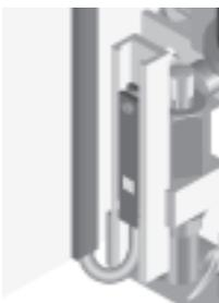
**1** Näherungsschalterkabel werden über Profilkuten im Seitendeckel und in der Grundplatte verlegt.
