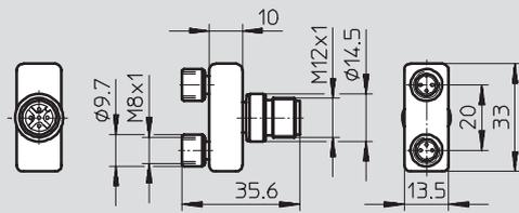
Dosen M12x1, 3-polig / Stecker M12x1, A-codiert, 5-polig
