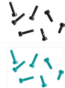
Abbildung 121: Schrauben 1. Binarisiert, 2. als BLOB / Objekt erkannt
