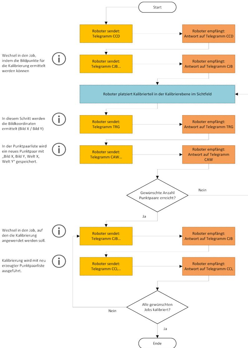
Abbildung 60: Automatisierter Ablauf zur Kalibrierung via Punktpaarliste
