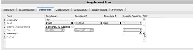
Abbildung 334: Aktivierung EtherNet/IP in Vision Sensor Configuration Studio
