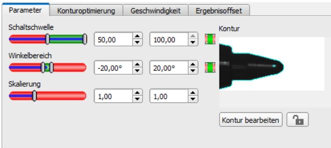
Abbildung 84: Lagenachführung Konturvergleich, Reiter Parameter
