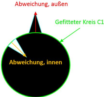
Abbildung 135: Orientierungsrichtung "Abweichung, innen" und "Abweichung, außen"
