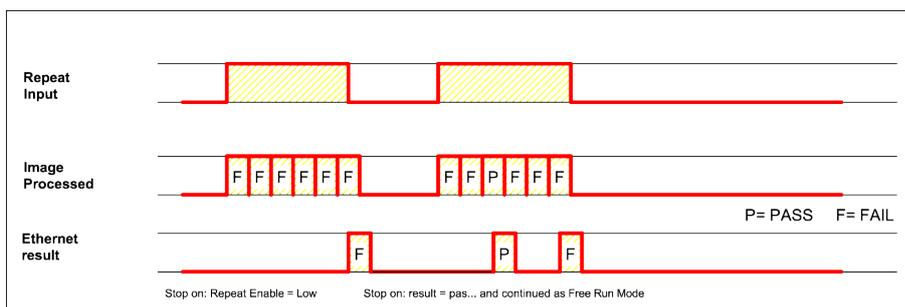
Abbildung 179: Eingang: Repeat Mode Enable, im Freilauf
