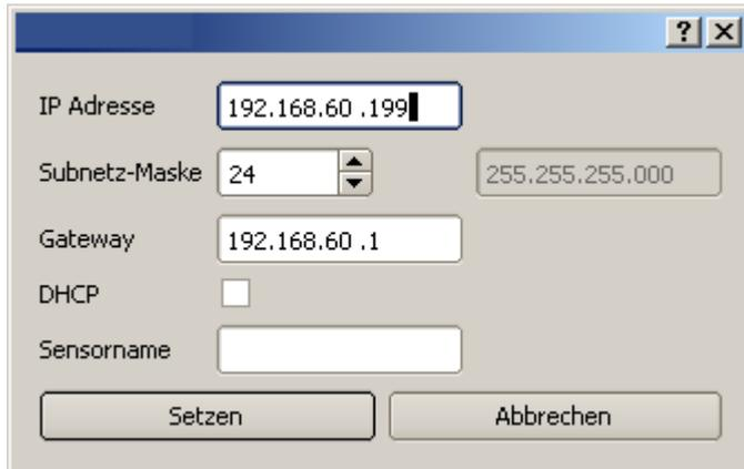
Abbildung 42: Vision Sensor Device Manager IP Setup
