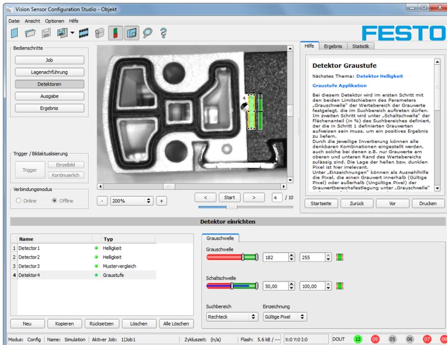
Abbildung 108: Graustufe, Applikationsbeispiel, positives Ergebnis
