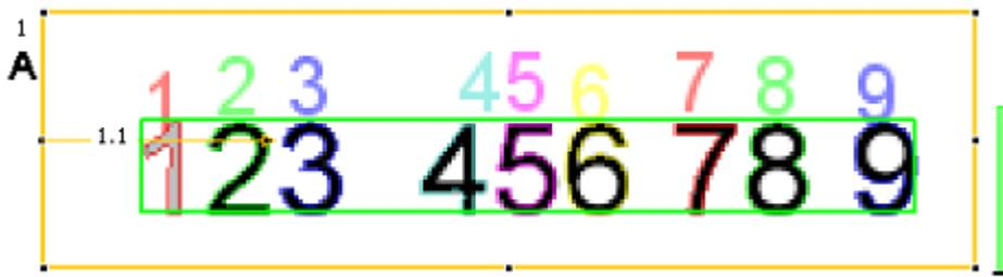
Abbildung I 51: Abbildung I 13: Segmentierung mit Vorgabe für Parameter „Gruppierung der Zeichen“ „3 3 2 I“: Auch das in der Helligkeit abweichende Zeichen wird segmentiert.
