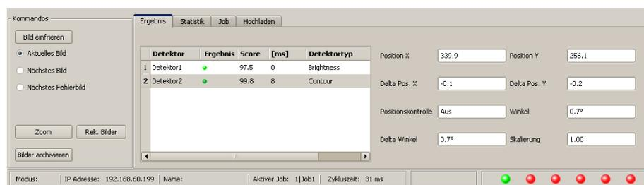
Abbildung 214: Abbildung, Vision Sensor Visualisation Studio, Ergebnis
