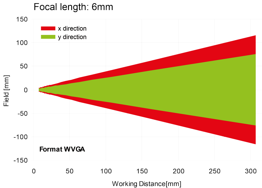
Abbildung 1: Sichtfeldgröße 6mm Objektiv, intern
