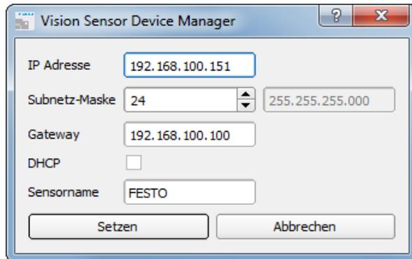
Abbildung 21: Vision Sensor IP Setup
