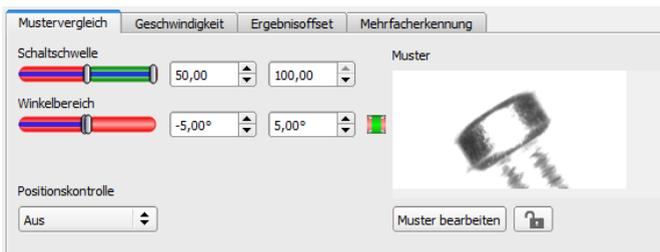
Abb. 110: Detektor Mustervergleich, Reiter Mustervergleich
