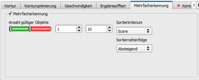
Abb. 136: Detektor Kontur 3D, Reiter Mehrfacherkennung
