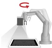
Die Kalibriermethode "Hand-Eye-Kalibrierung (Roboter)" dient dazu, den Bezug zwischen Werkzeug-Koordinatensystem (TCP) und Kamera-Koordinatensystem zu ermitteln (Position und Ausrichtung), wenn der SBS am Greifer montiert ist.
