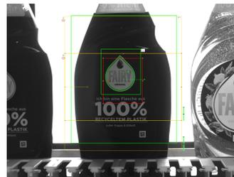
Abb. 237: Fall 2: Etikett nicht korrekt aufgebracht
