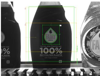
Abb. 236: Fall 1: Etikett korrekt aufgebracht
