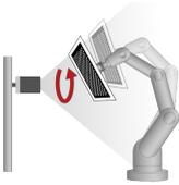
Die Kalibriermethode "Base-Eye-Kalibrierung (Roboter)" dient dazu, den Bezug zwischen Kamera-Koordinatensystem und Roboter-Basis zu ermitteln (Position und Ausrichtung), wenn der SBS Vision-Sensor stationär montiert ist.
